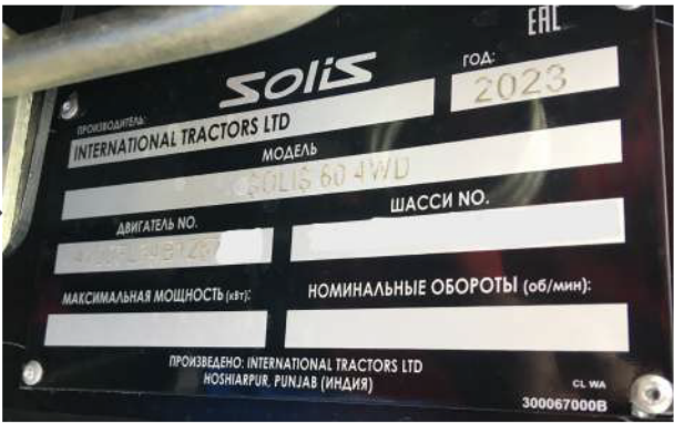
Рис.1-3. Пластина с основными характеристиками, установленная на задней стороне трактора
