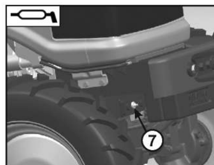
7. Штифт шарнира передней оси
